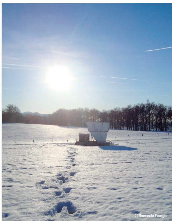
Mesures de vent par sodar, appareil qui utilise les ondes sonores pour mesurer la vitesse et la direction des vents
