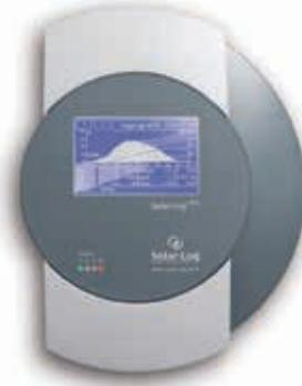
*Illustration 50: Le système de communication Solar-Log est l'un des rares produits de surveillance compatible avec de nombreuses marques d'onduleurs (Solare Daten-systeme GmbH).*
