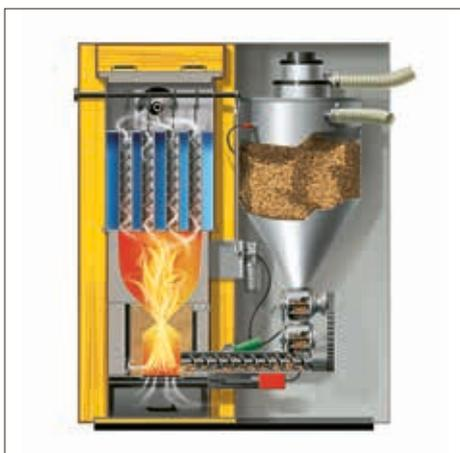
*Illustration 137: Vue en coupe d'une chaudière à granulés avec réservoir intermédiaire (Hargassner).*
