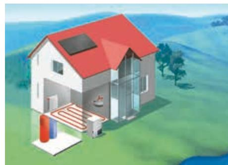
Illustration 99: Principe de disposition extérieure d'une pompe à chaleur air-eau.
