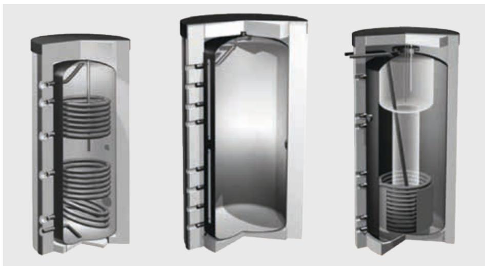
*Illustration 29: Les trois principaux types d'accumulateurs utilisés dans les installations solaires: Accumulateur d'eau sanitaire bivalent (à gauche), accumulateur-tampon (au centre) et accumulateur combiné, système Tank-in-tank (à droite).*
